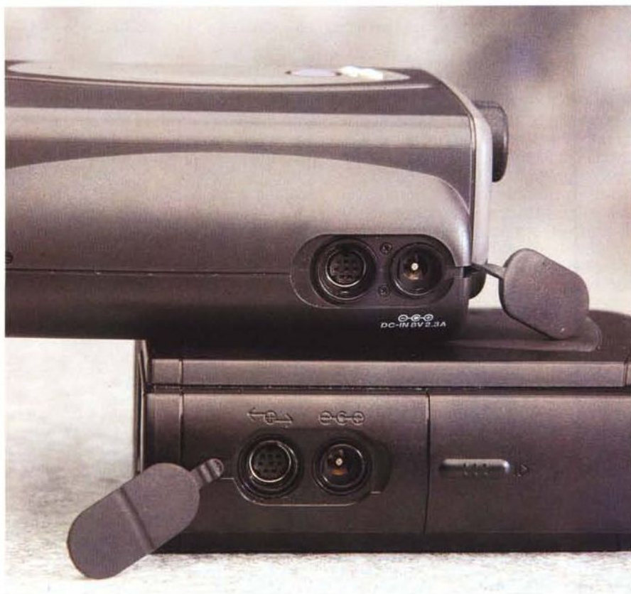
Entrambi gli apparecchi hanno un'interfaccia seriale e una presa per l'eventuale alimentazione esterna.
